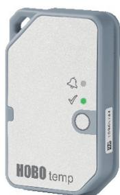
HOBO MX100 温度ロガーは屋内環境の温度を測定します。IP67環境評価を受けているので、湿気が発生する可能性のある屋内にロガーを設置することができます。このBluetooth® Low Energy対応のロガーは、モバイルデバイスとの無線通信用に設計されています。HOBOconnect®アプリを使用して、ロガーの設定、読み出し、スマートフォンやタブレットでのデータ表示、更なる分析のためのデータのHOBOlink®への自動アップロードを簡単に行うことができます。ロガーには、指定したしきい値で作動するように設定できるアラームが組み込まれています。交換不可能なリチウム電池で設計されたこのロガーには、バッテリー寿命を最大化するために、必要なときのみBluetooth信号を使用することができる省電力モードもあります。注：このロガーは、HOBO MXゲートウェイに対応していません。MX100ロガーとゲートウェイの互換性に関する質問については、Onset テクニカルサポートにご連絡ください。
